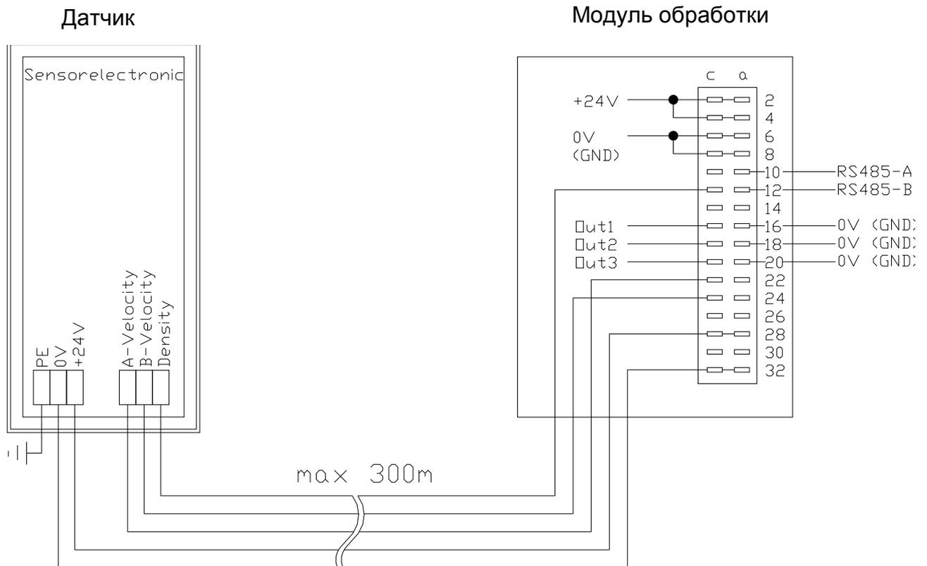
**Рис. 5:** Схема электропроводки между сенсором и модулем обработки.
