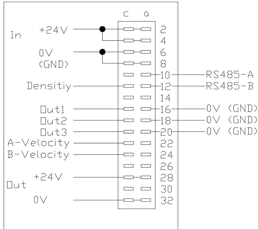
Рис. 6: Электрическое подключение
