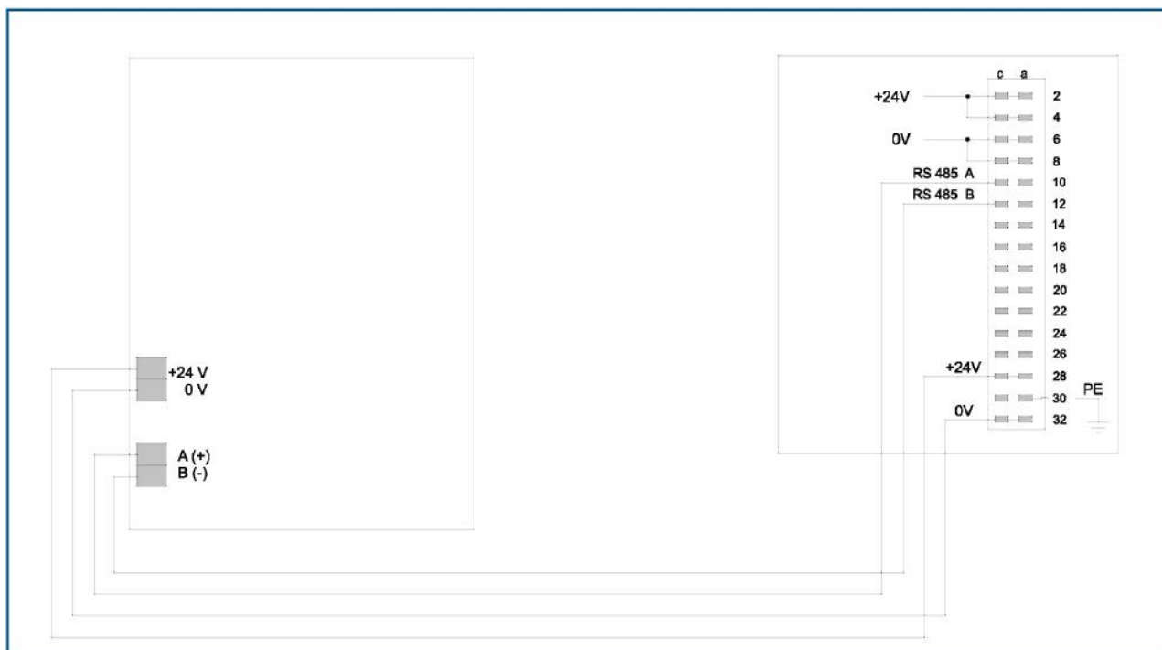
Рис. 7: Электропроводка между сенсором и модулем обработки версии 19“-выдвижной блок
